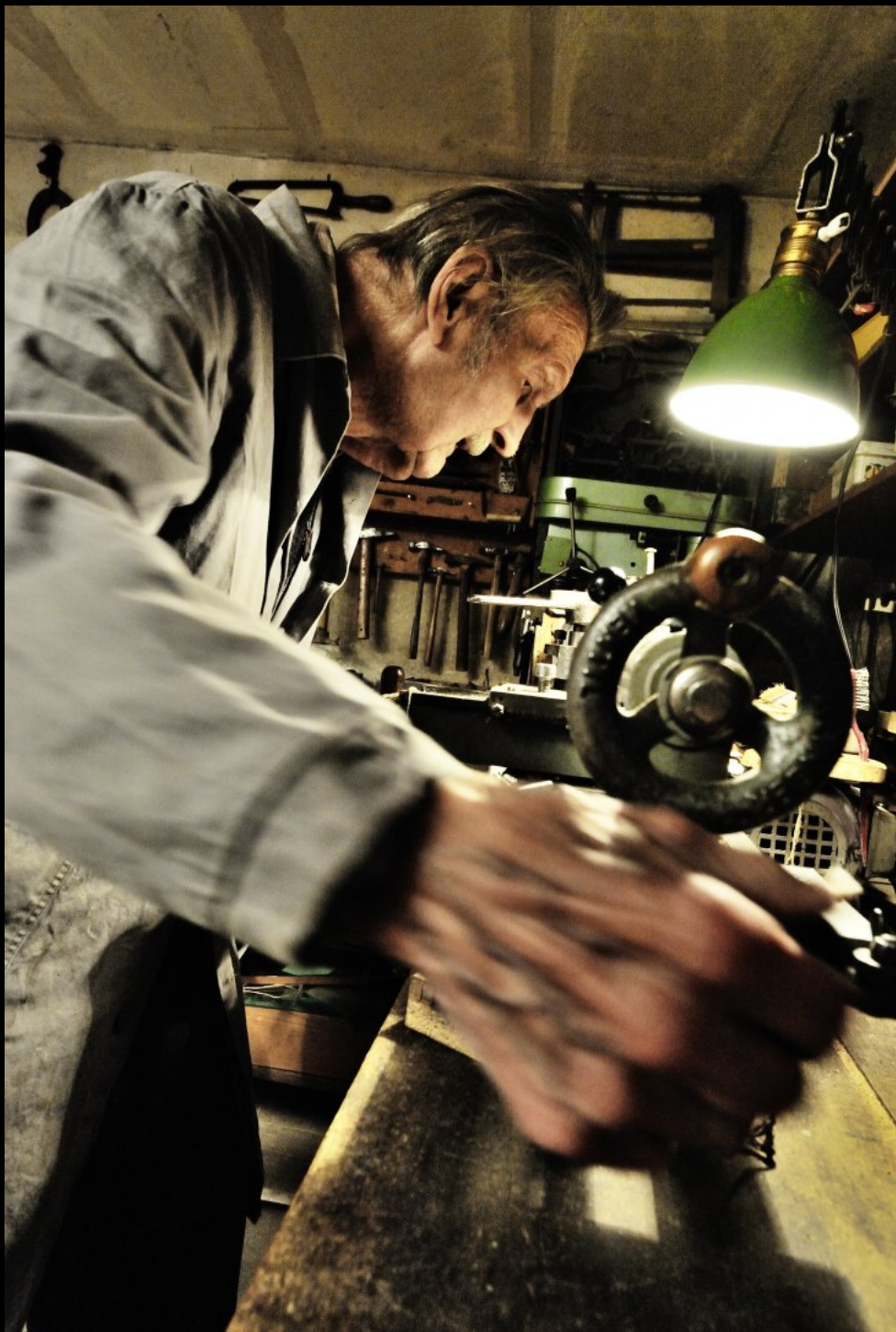
An der Drehbank werden zentrische Metallteile hergestellt. Kurt hat die Drehbank vor etwa 60 Jahren selbst gebaut. Mit einem Augenzwinkern gesteht er, dass er die Gussteile für das Gehäuse in Lohnarbeit vergeben hat.
