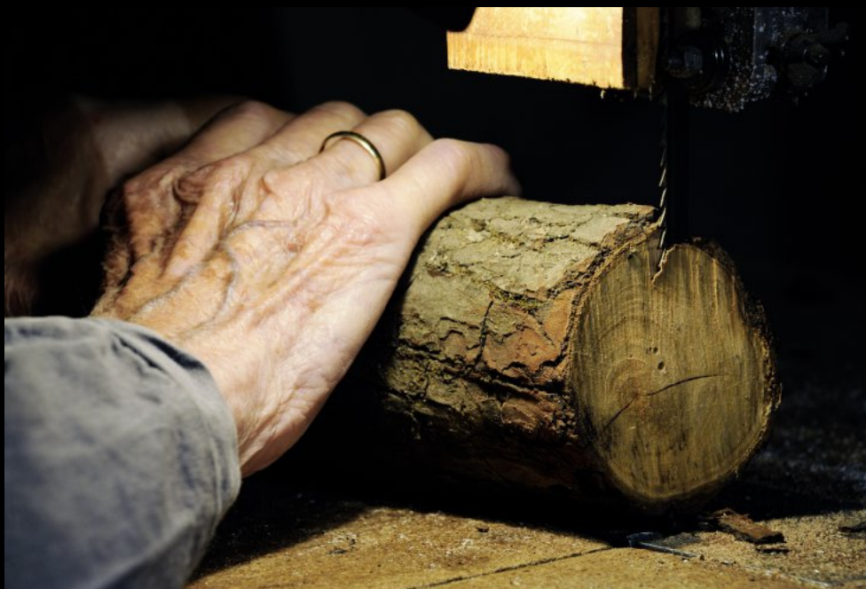
Zuschneiden eines Eichen-Rohlings mit der Bandkreissäge. Die Säge ist mit einfachen Mitteln selbst gefertigt.
