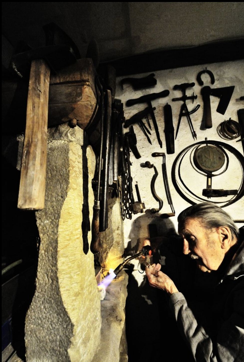
Ausglühen eines Messingnagels an der Esse mit der Lötlampe.
