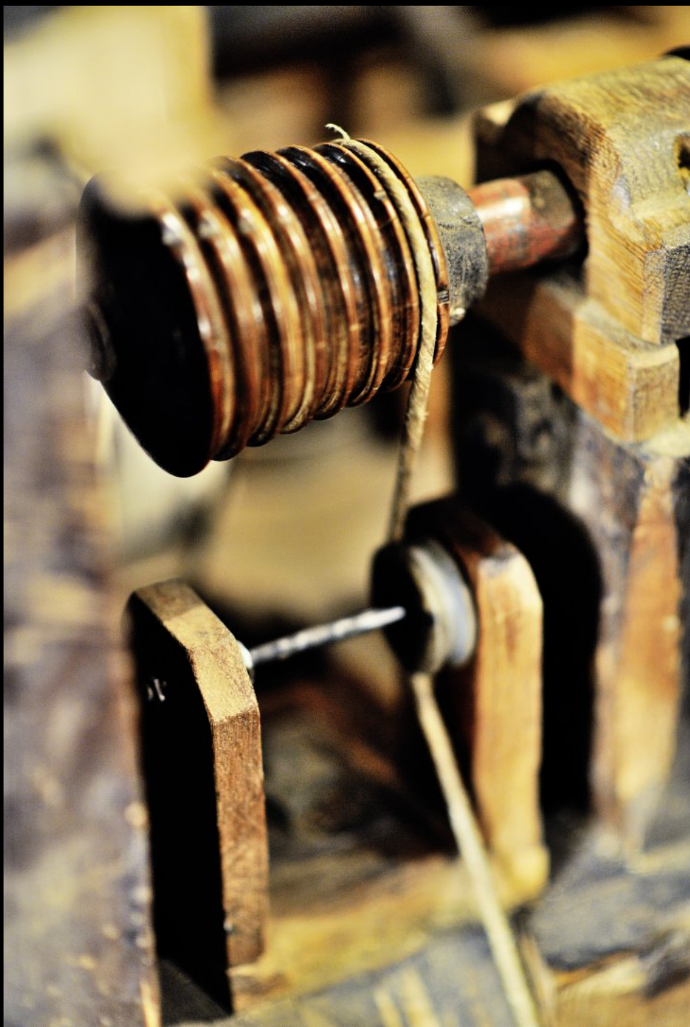
Die Antriebsspindel für die selbst gebaute Drechselmaschine. Ein Spagat überträgt das Drehmoment vom Fusspedal auf das Werkstück. Weil die Maschine manuell angetrieben wird, heisst sie "Schlapfendampf".
