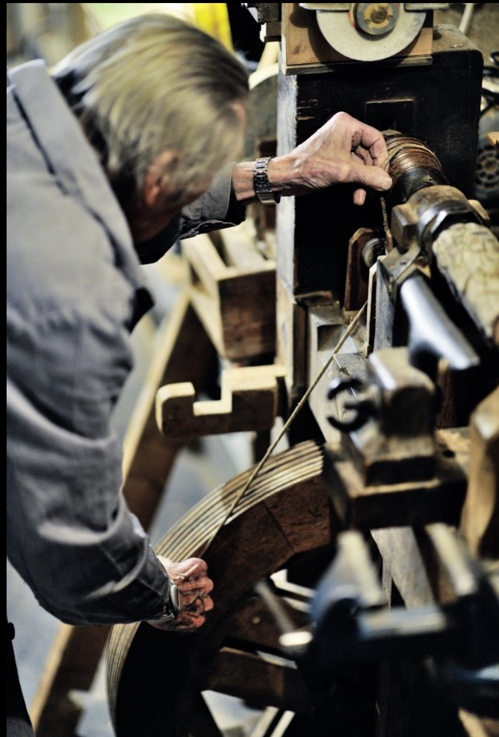
Der Spagat der Drechselbank hat sich durch das schnelle Antreiben gedehnt und muss nachgespannt werden.
