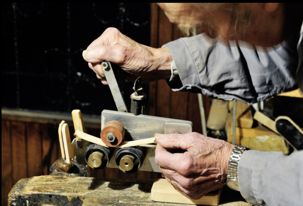
Biegen eines Schiffsspanns. Das Lärchenholz ist aus einem Ast gschnitten, handgehobelt und geschliffen. Um die Rundung für den Bug zu erreichen, muss das Holz vorgebogen werden.
