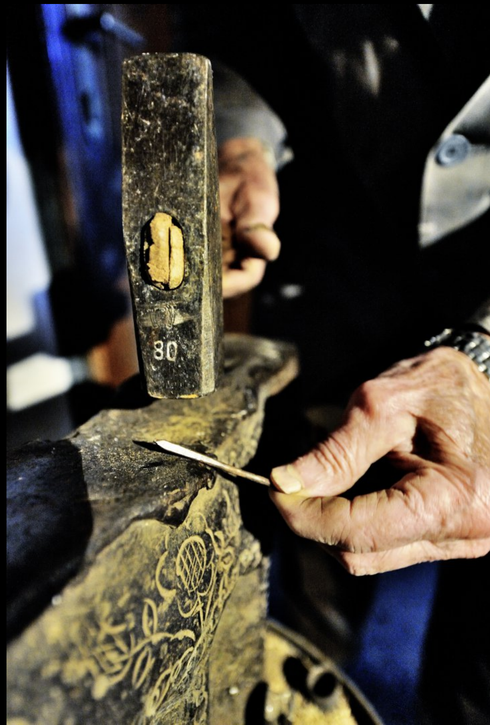
Kaltschmieden eines Ankers am Amboss, welcher schöne Zieselierungen aufweist.
