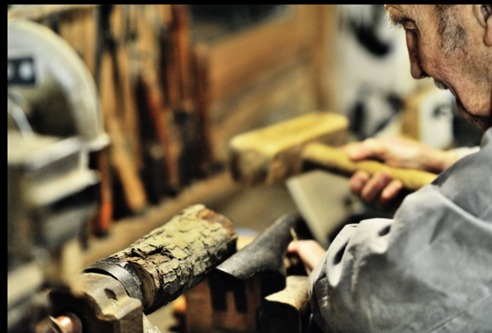
Spannen des Eichen-Rohlings auf die Drechselbank. Mit einem kräftigen Hammerschlag bohrt sich das Holz in den mittigen Aufnahmehorn.
