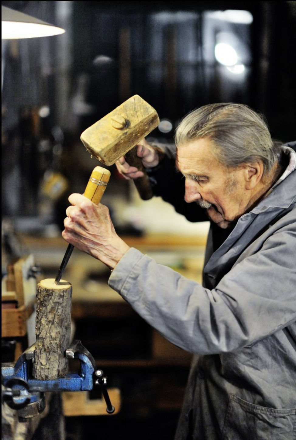
Vorbereitung eines Eichen-Rohlings für die Drechselbank. Die Stirnseite wird mit einem Stechbeitel plan gemesselt.
