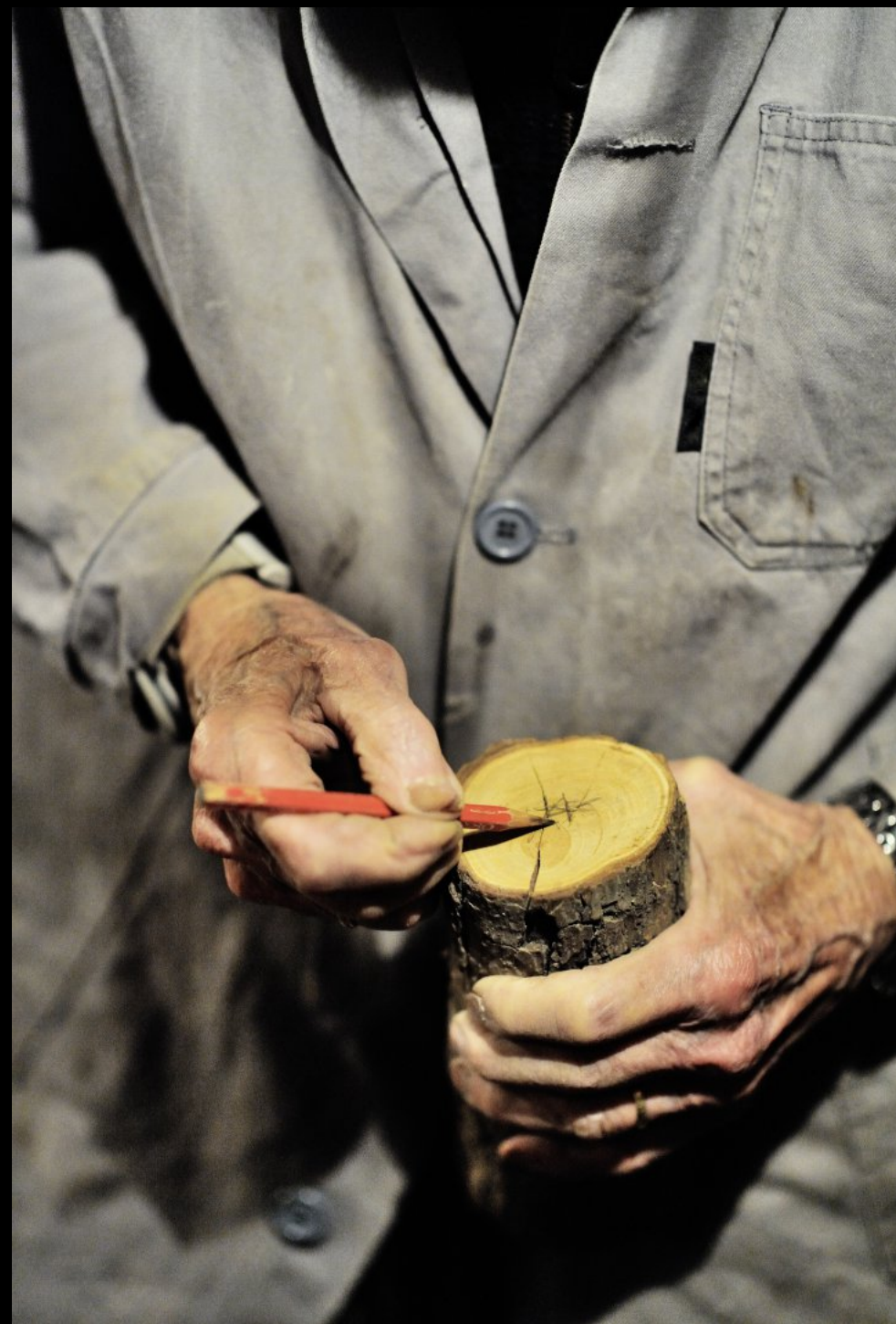
Anreissen der Mitte des Eichen-Rohlings zum zentrischen Spannen auf der Drechselbank.
