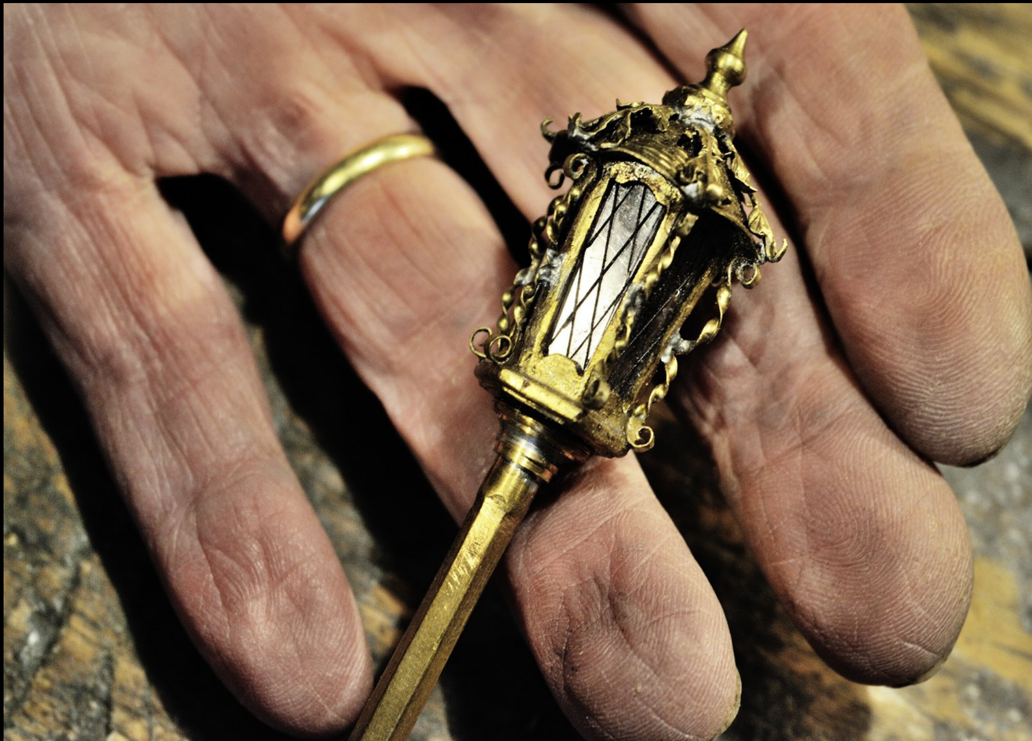
Kandellaber des Schiffes Theresia. Er ist aus geglühtem Messingblech getrieben. Die Negativform wurde aus Hartholz geschnitzt. Die Gläser werden genau eingeschnitten. Das Innenleben der Leuchtdioden und die Verkabelung ist diskret im Beleuchtungskasten und dem Steher versteckt.
