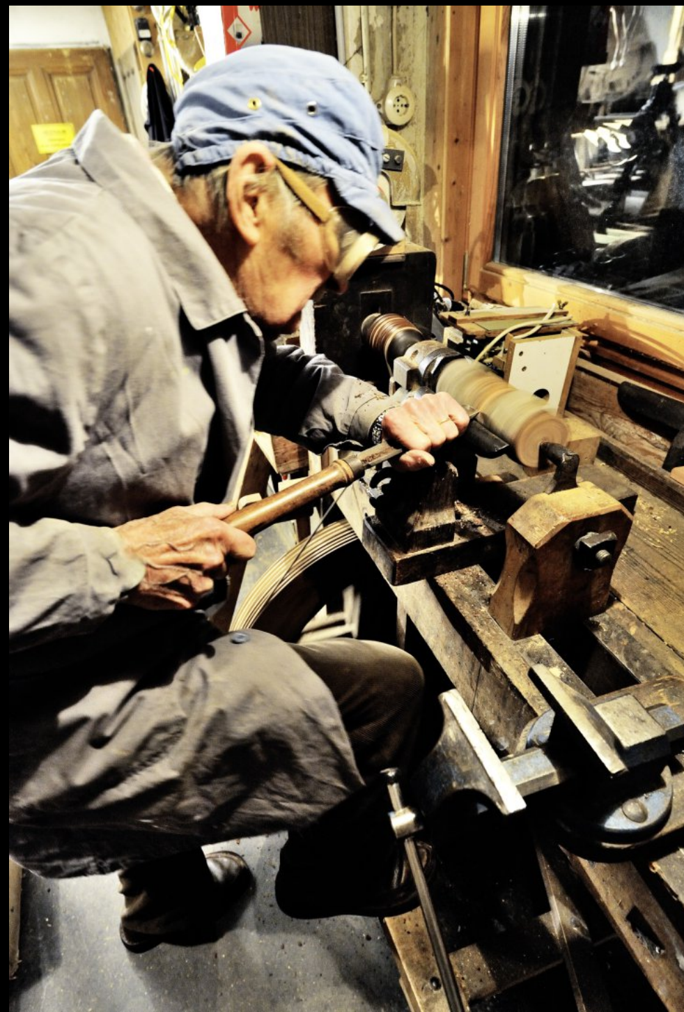
Erstaunlich, wie ausdauernd der 90-jährige Kurt Schäfer das Werkstück antreibt und gleichzeitig mit dem Meißel die Rinde abschält und dem Werkstück zielstrebig seine Form gibt.
