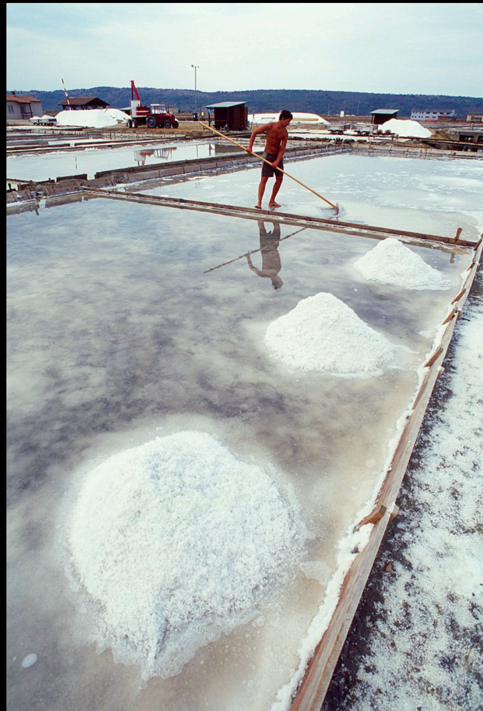
Ein Arbeiter im Verdunstungsbecken häuft mit einem Schieber das kristallisierte Salz an.
