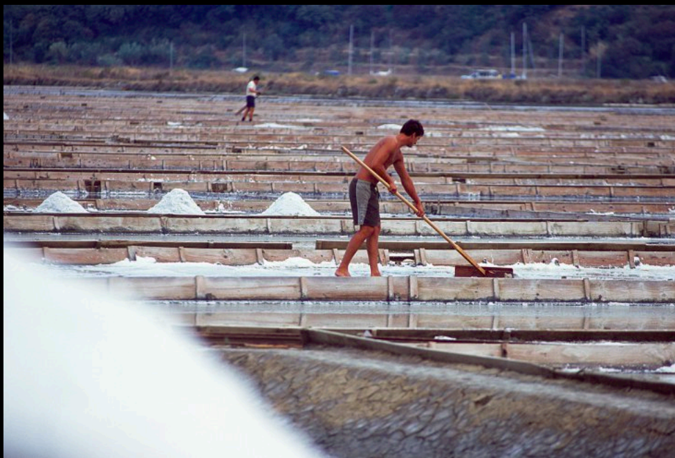
Durch die Sonneneinstrahlung verdunstet das Wasser der Sole (Wasser Natriumchlorid und andere Mineralstoffe). Die Salzkonzentration steigt, das Salz kristallisiert und setzt sich am Boden ab.
