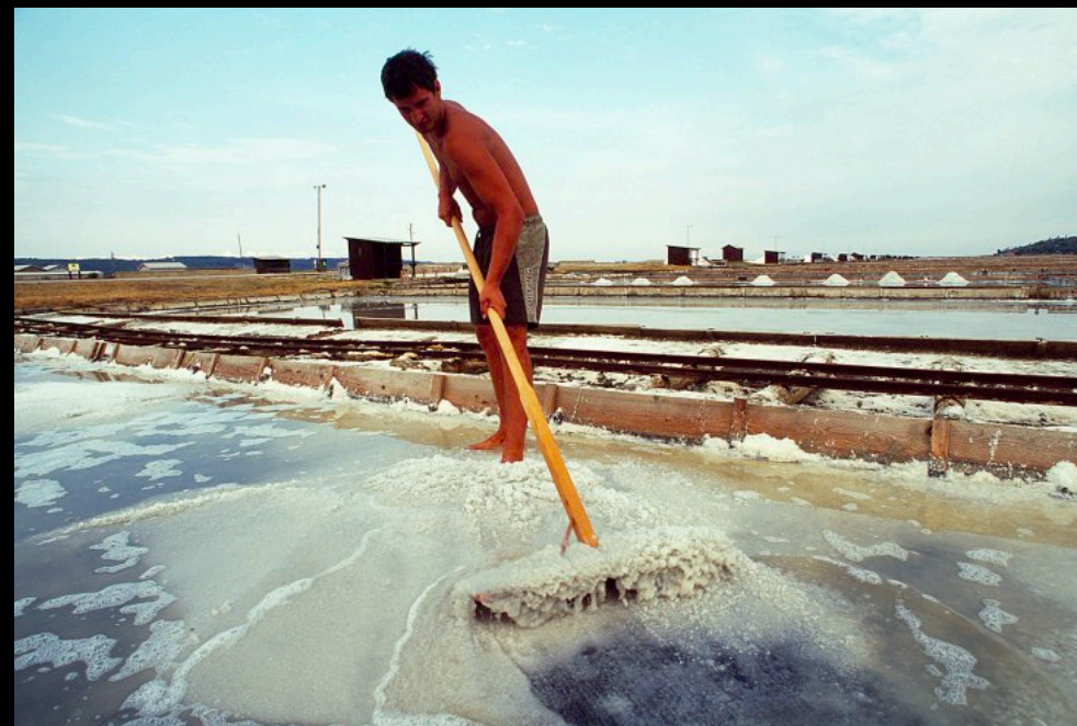
Mit einem Werkzeug, das einem Rechen hneln, wird das Salz vom Boden des Verdunstungsbeckens gesammelt.
