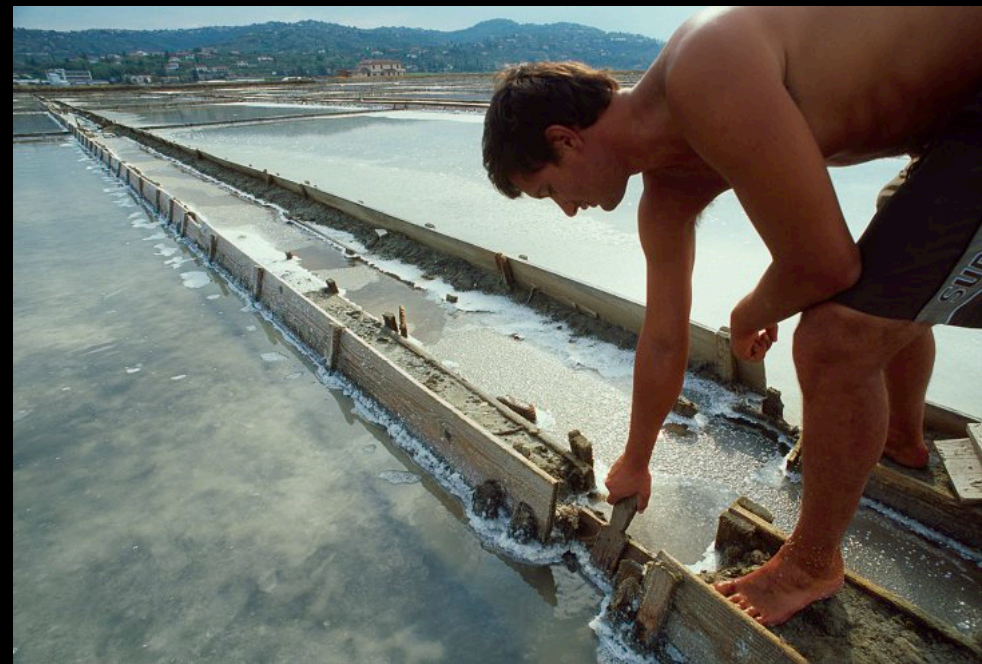
Je nach Witterung und Intensitat der Sonneneinstrahlung wird die Sole auf die einzelnen Becken verteilt.
