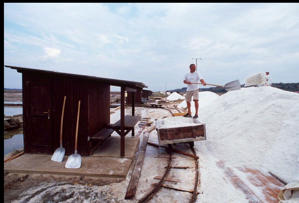
Das gewonnene, angehäufte Salz wird mit einer kleinen Draisine zum Lagerplatz gebracht.
