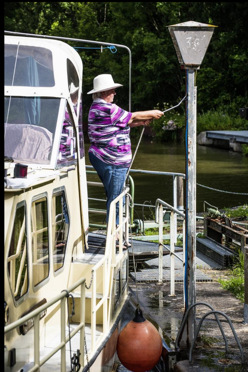
In der Schleuse wird das Boot entweder mit Leinen an Pollern festgemacht oder - wie hier zu sehen - mit einem Haken am Ufer festgehalten, damit das Boot nicht unkontrolliert in der Schleuse treibt.
